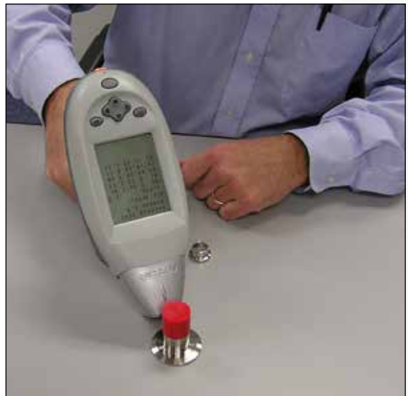
Prova d'identità della lega
